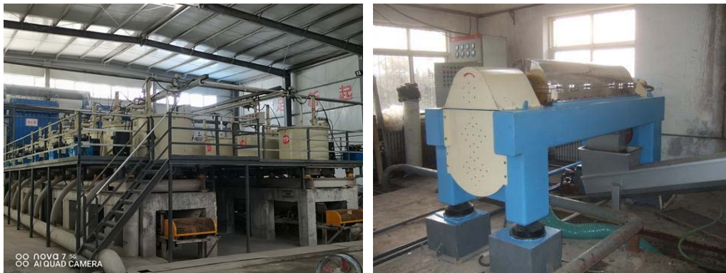
上面两个图片中的机器都安装了减振器
